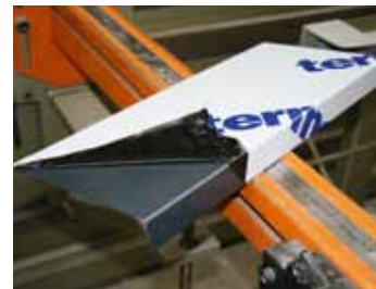
Keine Rissbildung im beschichteten Zustand
