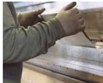
Hervorragende Kantqualität – t = 1 bei bis zu 3,0 mm Materialstärke!
